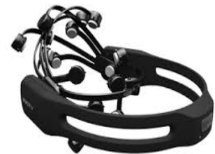
Figure 3 – EEG EPOC Emotiv headset
